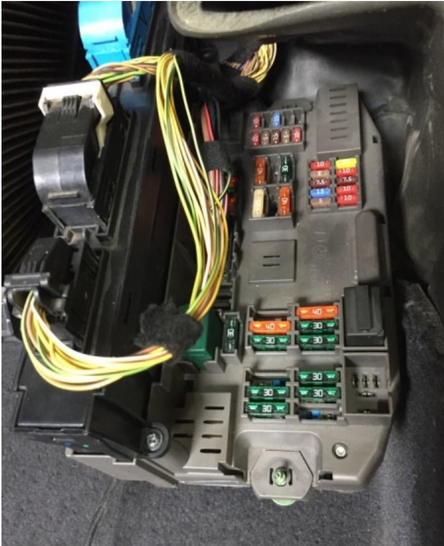
Gesamtdiagramm des Blocks mit Sicherungen und Relais
